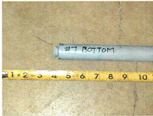
(b) Failure mode 2 (Pull-out)
